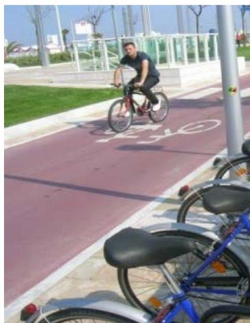
*]....1. Piste ciclabili in sede propria: La pista ciclabile in sede propria può essere realizzata ad unico o doppio senso di marcia ed è separata dalla sede destinata ai veicoli a motore e ai pedoni attraverso spartitraffico longitudinali fisicamente invalicabili.*
