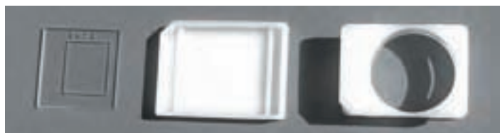
Figura 8 il dosimetro ANPA/Arpa con il rivelatore CR39
