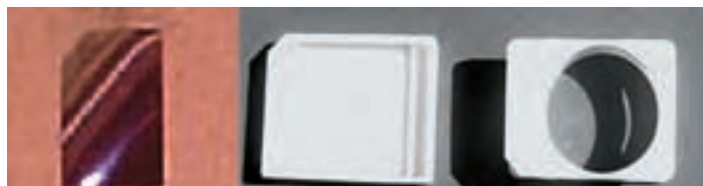
Figura 7 dosimetro ANPA/Arpa con il rivelatore LR115
